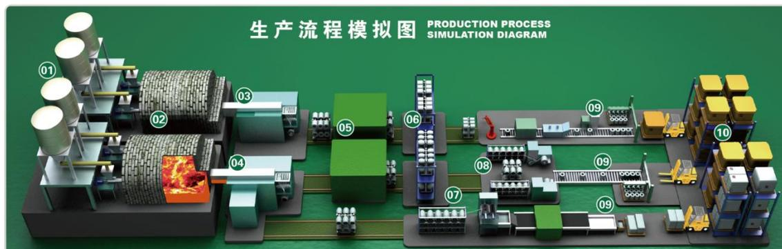
玻璃纤维是一种性能优异的无机非金属材料，种类繁多，优点是绝缘性好、耐热性强、抗腐蚀性好，机械强度高，通常用作复合材料中的增强材料，电绝缘材料和绝热保温材料，电路基板等国民经济各个领域，是国家重点鼓励发展的新材料产业。它是用叶腊石、高岭土、石灰石、石英砂等矿石为原料（上图 1 各种矿石按照比例配制）经高温熔制（上图 2）、拉丝（上图 3 和 4）、烘干（上图 5）、络纱（上图 7）等工艺制造而成，其单丝直径为几微米到二十几微米，相当于一根头发丝的 1/20-1/5，每束纤维原丝都由数百根甚至上千根单丝组成。玻璃纤维主要成分为二氧化硅、氧化铝、氧化钙、氧化硼、氧化镁、氧化钠等，根据玻璃中碱含量的多少，可分为无碱玻璃纤维、中碱玻璃纤维和高碱玻璃纤维，其中无碱玻璃纤维占据 95% 以上的产量规模。
